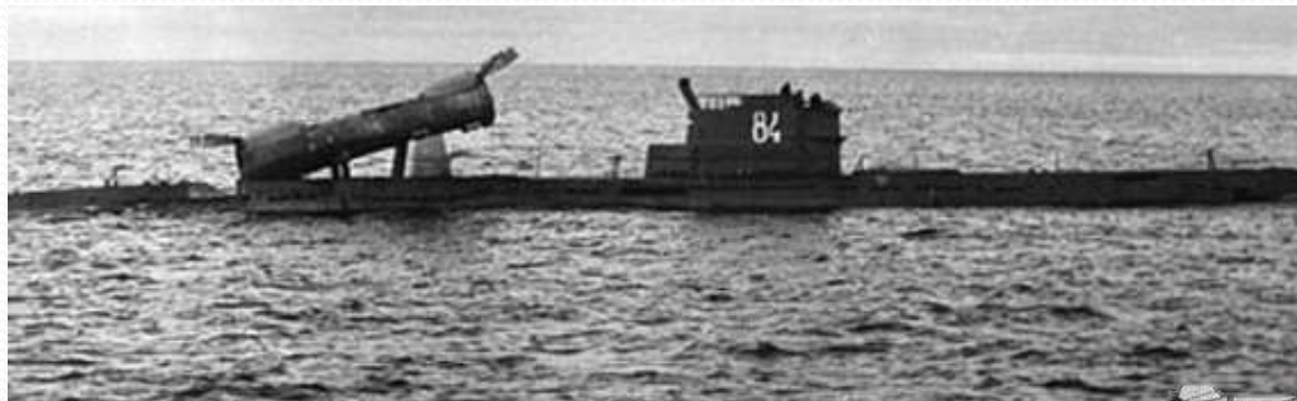
Подводная лодка С-146 проекта П613 на испытаниях. Ракетный контейнер находится в боевом положении.
